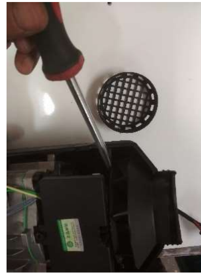
Vær forsiktig hvis viftehjul subber bort i og må flyttes lenger ut på aksling. Bend forsiktig med 1 skrujern på hver side.
