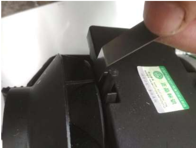
Avstand hovedkort/sensor og viftehjul ca 1mm.
